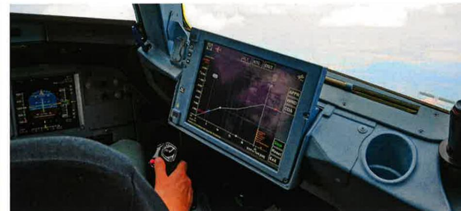
Vom seitlich im Cockpit angebrachten Bildschirm – so musste er nicht zertifiziert werden – erhalten die Piloten vom LNAS die Angaben, wann sie Gas reduzieren, Klappen setzen und Fahrwerk ausfahren sollen, um möglichst leise anzufliegen. Foto DLR
