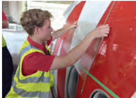
Swiss hat ihre Boeing 777-300ER mit treibstoffsparenden «Aeroshark»-Folien überzogen. | Swiss a apposé sur ses Boeing 777-300ER de films «Aeroshark» permettant d'économiser du carburant.
